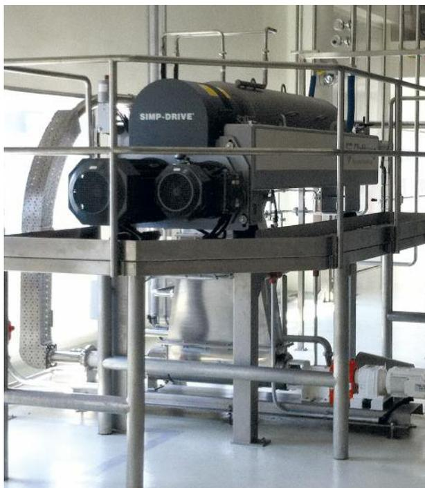
Décanteur modèle Z4E dans la production de lait de soja
