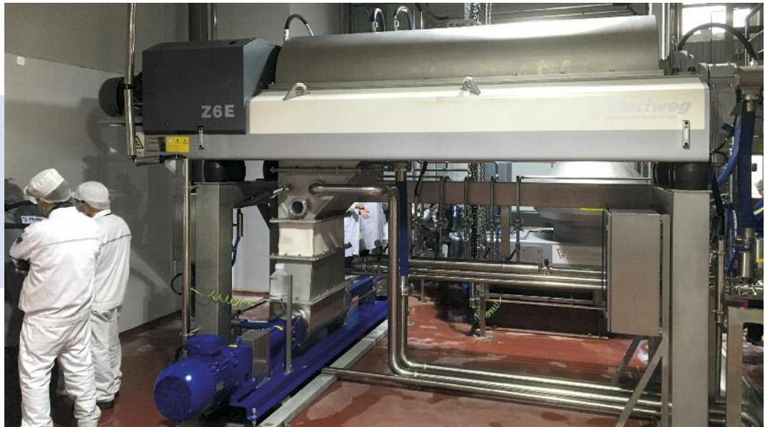
Décanteur type Z6E utilisé dans la production de lait de soja
