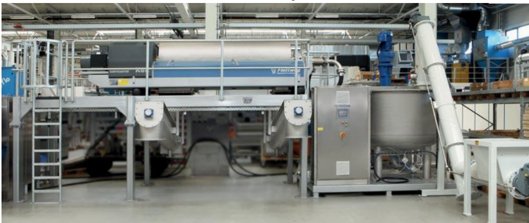
Von links: SORTICANTER® mit Feststoffaustrag schwere Phase, leichte Phase, Anmischbehälter und Dosierung
