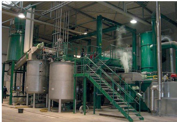
FLOTTWEG SORTICANTER® Anlage zur Rückgewinnung von Polyolefinen aus Mischkunststoff in einem Betrieb in Deutschland
