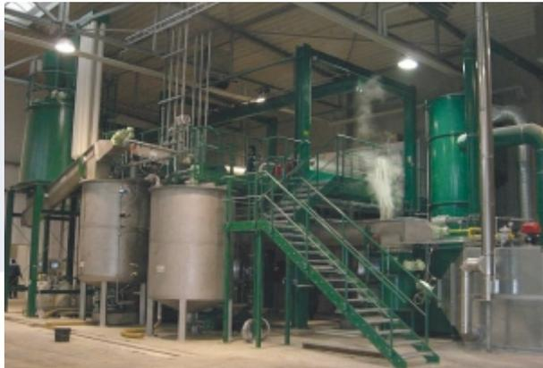
Sistema SORTICANTER® FLOTTWEG para recuperação de poliolefinas de plásticos mistos em uma empresa Alemã
