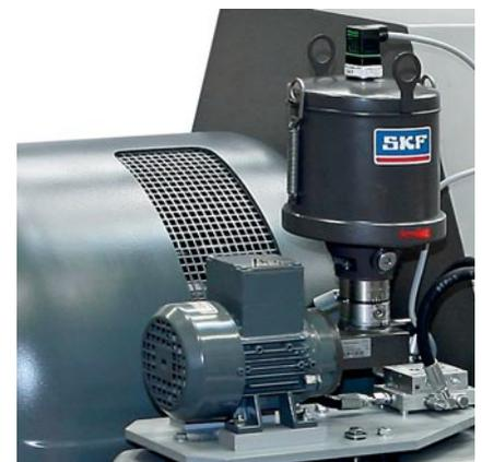
Sistema di lubrificazione automatico
