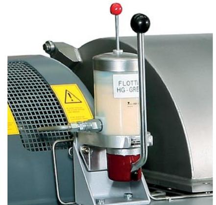
Sistema di lubrificazione centralizzato (manuale)
