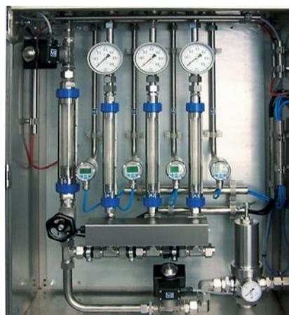
Sistema de control Flottweg para la purga de gases inertes
