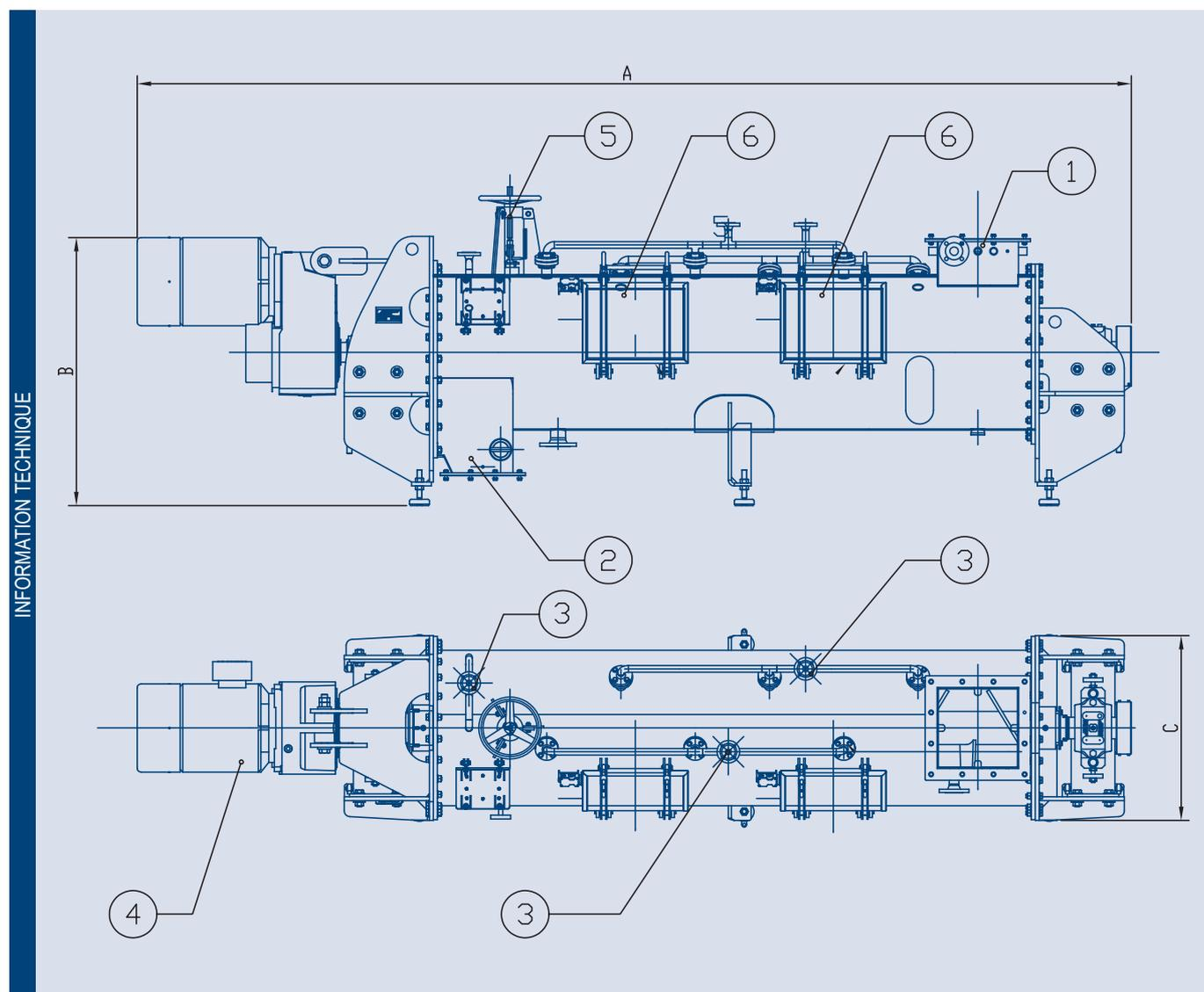
Raccordement 3,4,6 Raccord fileté DIN 118512
