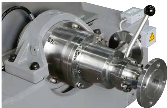
Устройства загрузки и разгрузки с рычагом управления для регулируемого импеллера Трикантера® Флоттвег
