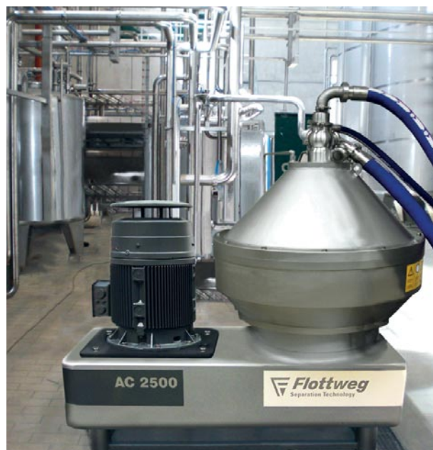
CENTRÍFUGA DE DISCOS FLOTTWEG, modelo AC2500, para la clarificación de jugos de fruta y mosto
