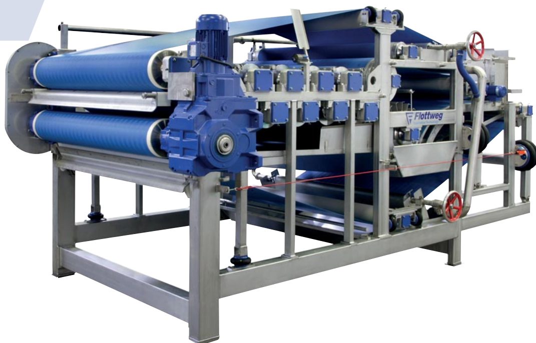
PRENSAS BANDA FLOTTWEG para la extracción de jugos de manzana
