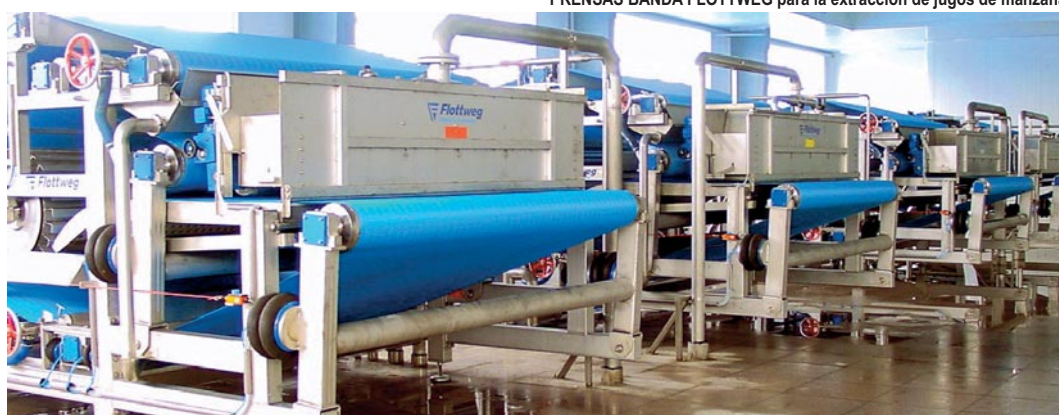
PRENSAS BANDA FLOTTWEG para la extracción de jugos de manzana
