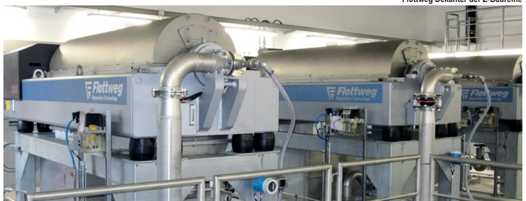
Flottweg Sedicanter® werden zur kontinuierlichen Abscheidung von feinen Feststoffen aus Flüssigkeiten eingesetzt, wobei die Feststoffe ein weiches bis fließfähiges Sediment bilden. Flottweg Sedicanter® werden bevorzugt dann verwendet, wenn die Feststoffe zur Verarbeitung mit Dekantern zu feinkörnig sind, das Sediment sich wegen der weichen Konsistenz schlecht aus Dekantern austragen lässt bzw. die Klärwirkung von Dekantern nicht ausreicht.
