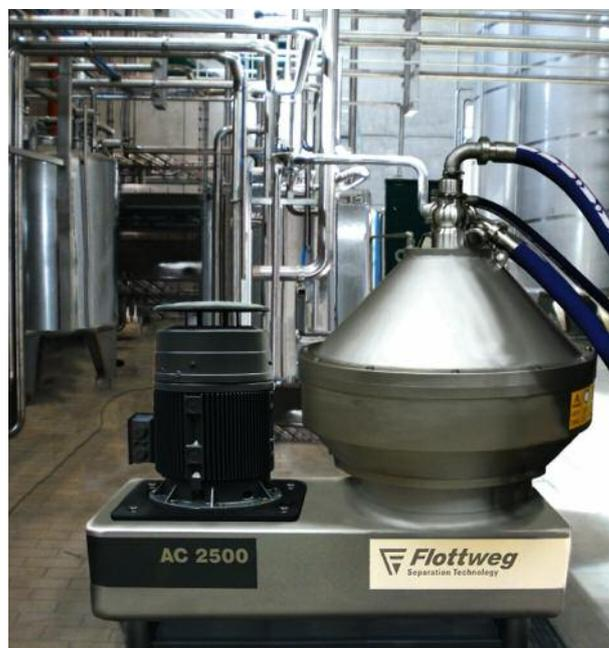
Centrifugeuse à Assiettes Flottweg, modèle AC 2500, pour la clarification de jus de fruits et de vin
