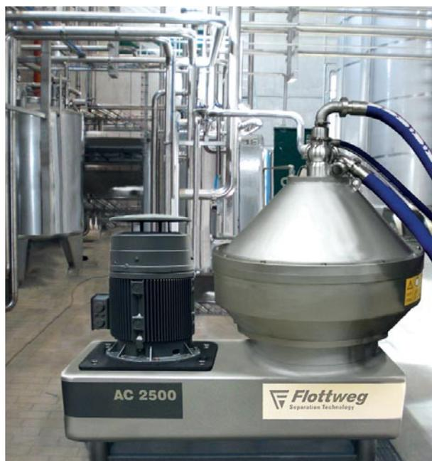
Le Centrifughe a Dischi Flottweg, modello AC 2500, per la chiarificazione di succo di frutta e sidro
