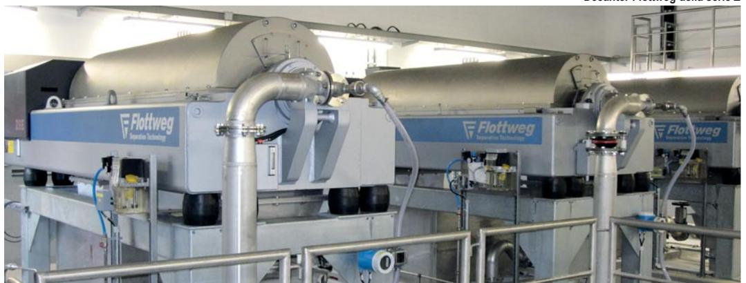
I Sedicanter® Flottweg si impiegano per la separazione continua di solidi fini da liquidi nelle applicazioni in cui i solidi formano un sedimento da pastoso a fluido.
