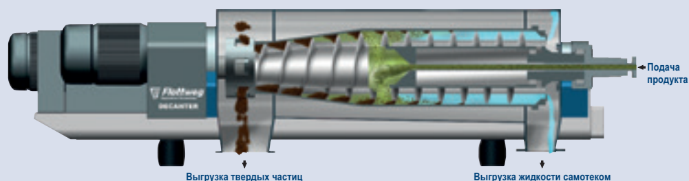
Декантер Flottweg для сепарации твердых веществ от жидкостей с выгрузкой жидкой фазы самотеком (фугата)
