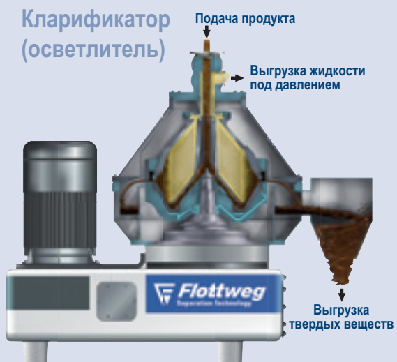
Кларификатор Flottweg для отделения твердых веществ от жидкостей
