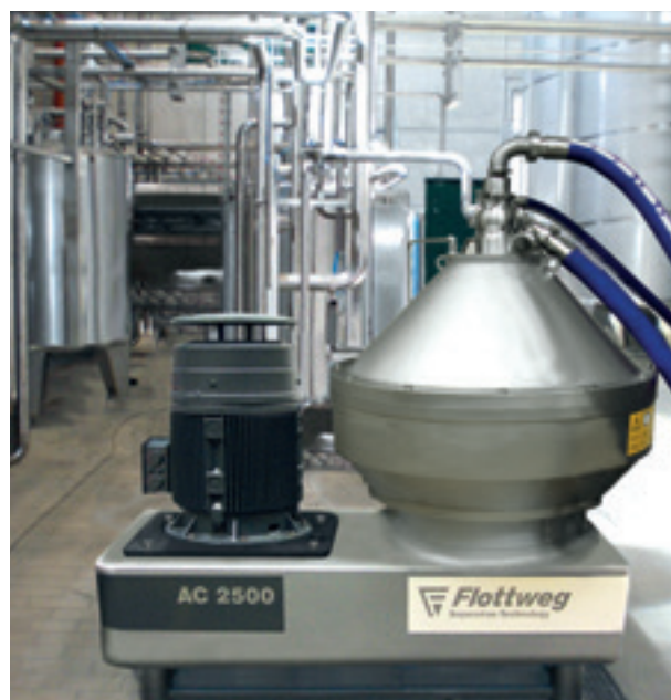
Тарельчатый сепаратор Flottweg, модель AC 2500, для осветления фруктового сока и вина.
