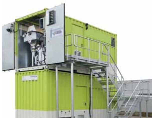
福乐伟用于油污泥处理的集装箱成套系统
