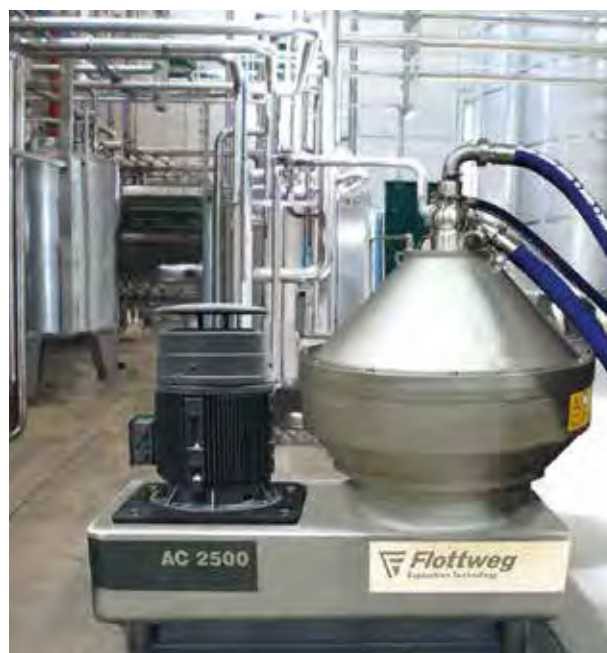
Separator Flottweg typu AC 2500 do klarowania soków owocowych i wina owocowego
