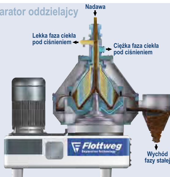
Separator rozdzielczy Flottweg do oddzielania dwóch wzajemnie nierozpuszczalnych cieczy z jednoczesnym oddzielaniem fazy stałej
