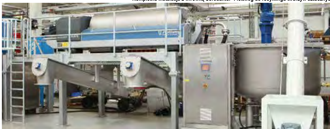
Kompletna instalacja z wirówką Sorticanter® Flottweg do recyklingu tworzyw sztucznych
