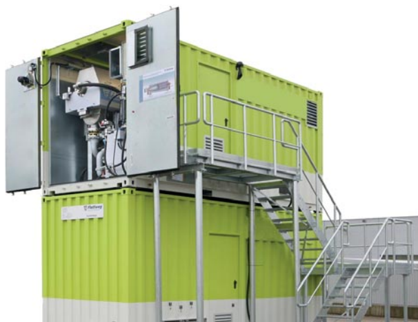
Sistema de Container da Flottweg para o processamento de lodo oleoso
