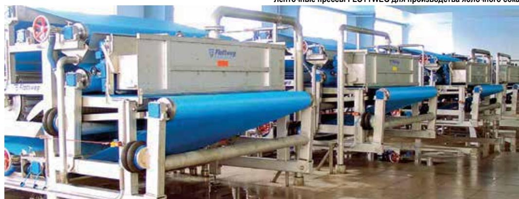
Ленточные прессы FLOTTWEG для производства яблочного сока
