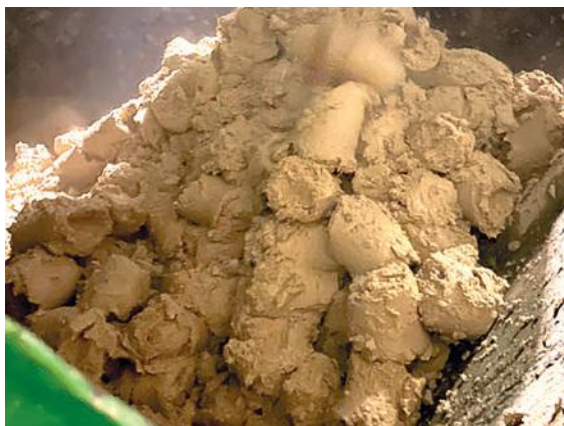
Okara nach dem Dekanter: Maximale Ausbeute durch hohe Entwässerung der Feststoffe.
