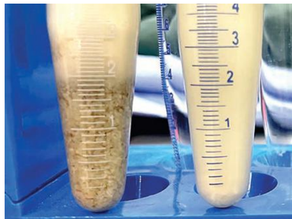
Hafermilch vor- und nach der Zentrifuge. Beste Produktqualität durch optimale Abscheidung.
