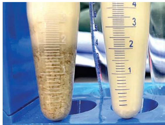
Latte di avena prima e dopo la centrifuga. Massima qualità del prodotto grazie alla separazione ottimale.
