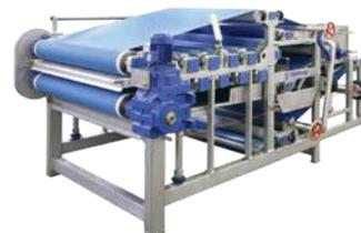
Lo speciale profilo del rullo e la guida del nastro garantiscono l'alternanza di pressione e carico di taglio. Ciò garantisce un drenaggio rapido ed efficiente.
