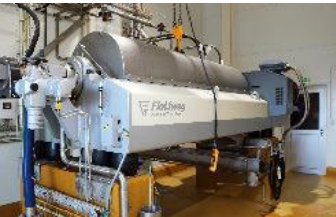
Dekanter von Flottweg gewinnen aus Kartoffeln Protein, das getrocknet als Futtermittel eingesetzt wird
