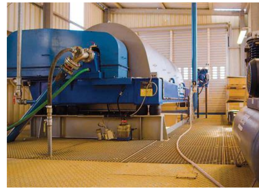
Die Dekanterzentrifuge Z92 von Flottweg verarbeitet bis zu 15 t des Materials pro Stunde.
